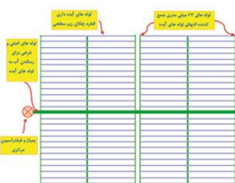
۳- شکل شماتیک یک مجموعه آبیاری تیب شامل بخش پمپاژ، لوله های آب رسان و لوله های دارای قطره چکان زیر سطحی
