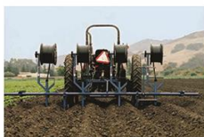
شکل ۷- حفر مسیر لوله های آینده قطره چکان با دستگاه ترنچر برای یونجه
